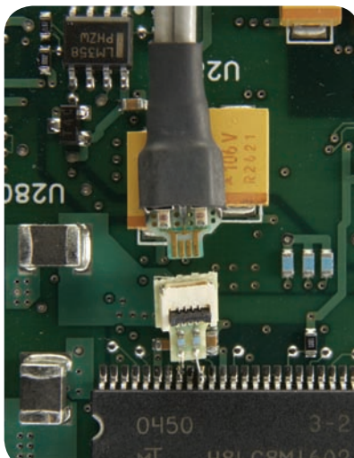
InfiniiMax ZIF tip soldered on board
