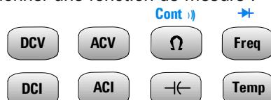
Les fonctions de continuité et de test de diode sont accessibles via la touche Shift (en bleu). Par ex., pour sélectionner continuité, app. sur :
