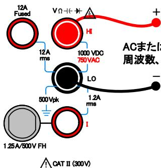
ACまたはDC電圧、キャパシタンス、導通、ダイオード・テスト、周波数、抵抗、温度の測定
