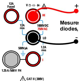
Mesures : tension CA ou CC capacité, continuité test de diodes, fréquence, résistance ou température
