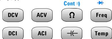
연속 및 다이오드 테스트 기능은 Shift 키를 통해 변환됩니다(파란색으로 표시). 예를 들어 연속을 선택하려면 다음을 누릅니다.
