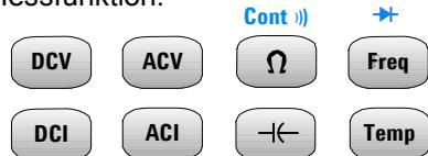
Die Durchgangs- und Diodentestfunktion (blau) erfordern die Umschalttaste. Die Durchgangstestfunktion wählen Sie so:
