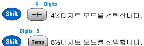
참고: 연속 및 다이오드 테스트 기능은 고정된 4½디지트 디스플레이를 사용합니다. 캐패시턴스 및 온도는 고정된 3½디지트 디스플레이를 사용합니다.
