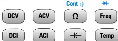
導通およびダイオード・テスト機能はシフト機能です(青で表示)。例えば、導通測定を選択するには、次のようにキーを押します。
