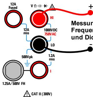
Messung von Wechsel und Gleichspannung Kapazität, Frequenz, Widerstand und Temperatur sowie Durchgangs und Diodentests
