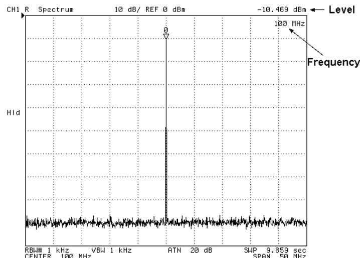
Figure 8-1. Marker Readout
